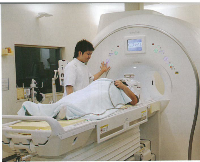
1.5テスラのMRI。従来型よりも口径が1.5倍ほどあり、幅も10センチほど広い。心理的な圧迫感が小さく、狭い場所が苦手な人にも優しい
